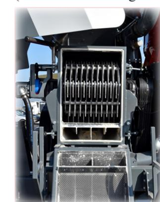
Weise möglich. Durch die ausgewogene Materialverteilung und die effektive Schlägerbestückung sind Mahlleistungen von bis zu 25 to/h Getreide keine Seltenheit.
